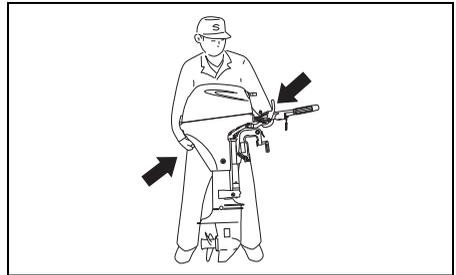
8. Den Außenbordmotor durch Festziehen der Spannschraube am Ständer anhängen.
