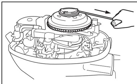
5. In den im Werkzeugkasten befindlichen Hilfsanlasser einen Knoten machen. Das andere Seilende am Griff des im Werkzeugkasten befindlichen Schraubenziehers festbinden.
