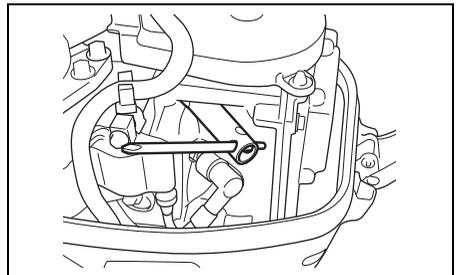
Zur Gewährleistung eines starken Zündfunksens sollten Sie die Zündkerzen in den auf der Wartungstabelle angegebenen Zeitabschnitten säubern und einstellen. Kohleablagerungen von Zündkerzen mit einer kleinen Drahtbürste oder mit Zündkerzenreiniger entfernen und Abstand gemäß folgender Tabelle einstellen:
