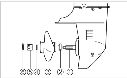
1. Schiebewelle ① der Schiffsschraube dick mit wasserabweisendes Fett gegen Rost einfetten.
