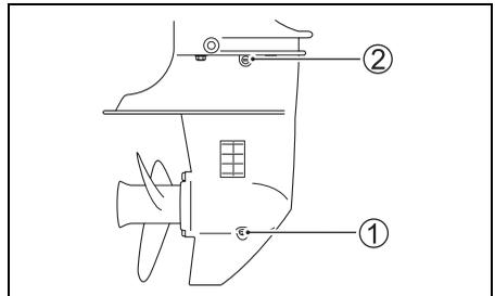
3. Nach völliger Leerung vorgeschriebenes Getriebeöl in untere Ablaßöffnung einspritzen, bis es aus der oberen Öffnung herauskommt. Dafür sind rund 0,25 L Öl erforderlich.
