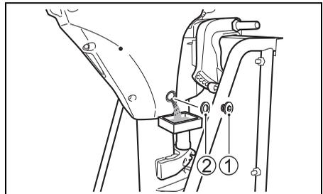
5. Nach dem Ablassen die Ölablaßschraube mit einem neuen Dichtring wieder anbringen.
