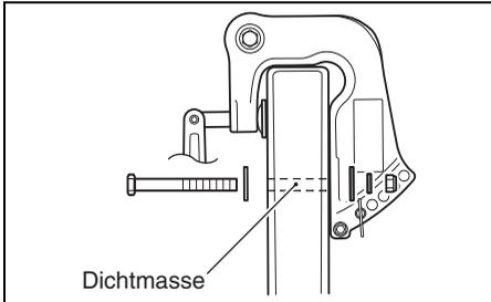
Nach dem Einbau des Motors sich vergewissern, daß Lenk- und Kippmechanismus nicht durch den Bootskörper behindert werden. Ebenso sicherstellen, daß das Batteriekabel (wenn vorhanden) nicht die Bewegung des Motors behindert.
