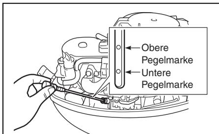
Der Ölstand muß sich zwischen der oberen und unteren Markierung am Ölmeßstab befinden.
