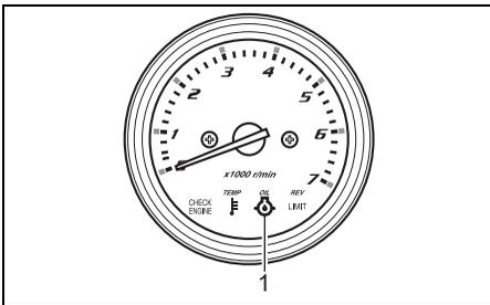
1. "OIL"-Lampe (Kontrollanzeigen-Drehzahlmesser)
