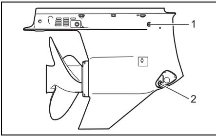
1. Getriebeöl-Kontrollschraube/Getriebeöl-Pegelöffnung (DF250S)
