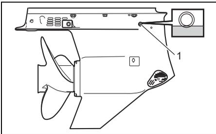
1. Getriebeöl-Kontrollschraube/Getriebeöl-Pegelöffnung (DF250S)
