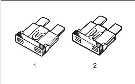
1. Normale Nebensicherung (30 A)/Normale Niederdruckkraftstoffpumpensicherung (15 A)
