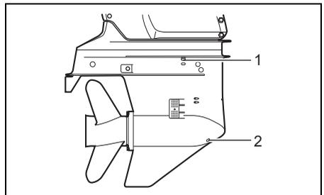
1. Entlüftungsöffnungsschraube/Entlüftungsöffnung (DF200, DF200Z, DF225, DF225Z, DF250, DF250Z)
