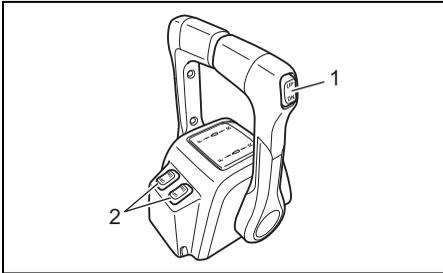
1. PTT-Schalter (Power Trim und Tilt) (an der Seite des Fernbedienungshebels)
