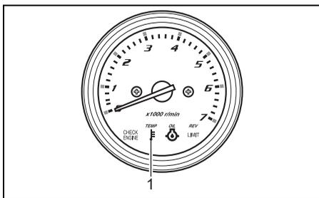
1. "TEMP"-Lampe (Kontrollanzeigen-Drehzahlmesser)
