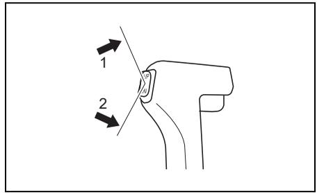
1. Obere Seite des PTT-Schalters (Power Trim und Tilt) (seitlich montiertes Fernbedienungsgehäuse)
