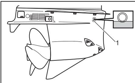
1. Getriebeöl-Kontrollschraube/Getriebeöl-Pegelöffnung (DF250W, DF250WZ)
