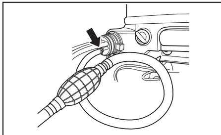
3. Sicherstellen, dass der Kraftstofftank des Bootes korrekt entlüftet ist und dass alle Leitungsfiter frei von Schmutz usw. sind. Wenn der Kraftstofftankdeckel über eine manuelle Entlüftung verfügt, sicherstellen, dass sie vollständig geöffnet ist.
