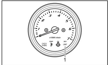
1. "REV LIMIT"-Lampe (Kontrollanzeigen-Drehzahlmesser)
