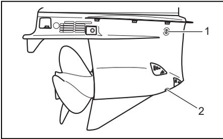
1. Getriebeöl-Kontrollschraube/Getriebeöl-Pegelöffnung (DF250W, DF250WZ)
