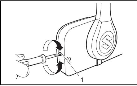
1. Drosselzugeinstellung (seitlich montiertes Fernbedienungsgehäuse)
