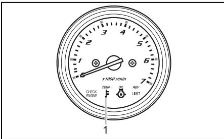
1. "TEMP"-Lampe (Kontrollanzeigen-Drehzahlmesser)
