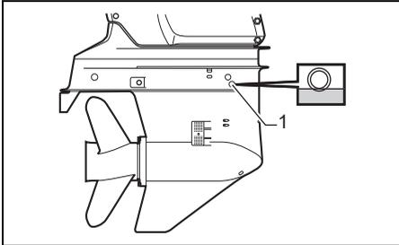
1. Getriebeöl-Kontrollschraube/Getriebeöl-Pegelöffnung (DF200, DF200Z, DF225, DF225Z, DF250, DF250Z)
