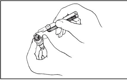
Wenn die Elektrode oder Isolierung beschädigt ist oder beide übermäßigen Verschleiß aufweisen, ist die Zündkerze auszutauschen.
