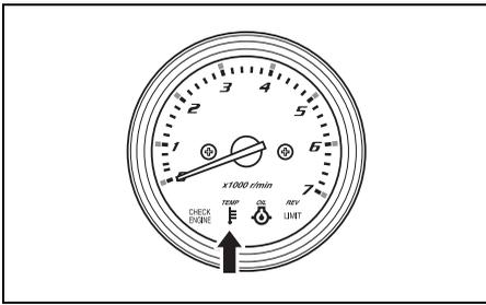
2. Wenn Sie weiterfahren, stoppt der Motor 3 Minuten nach Aktivierung des obigen Warnsystems automatisch.
