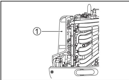
2. Die Schraube, die die Zündspule hält, entfernen.
