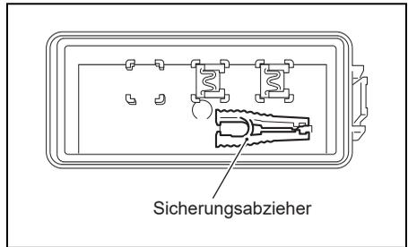
4. Die Hilfsbatteriekabelsicherung entfernen.
