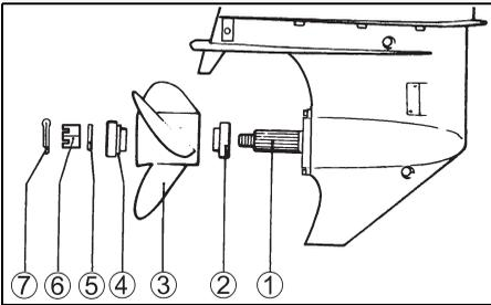
1. Propeller-Schiebewelle ① dick mit wasserabweisendem Fett von Suzuki gegen Rost einfetten.
