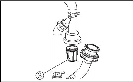
6. Überprüfen Sie den Filtergehäusedeckel ①, das untere Filtergehäuse ②, den Filter ③, den O-Ring ④, ⑤ und das obere Filtergehäuse ⑥ auf Schäden. Falls die Teile beschädigt sind, müssen sie ersetzt werden.
