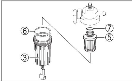
9. Den Filtereinsatz mit sauberer Reinigungslösung waschen und trocknen lassen.
