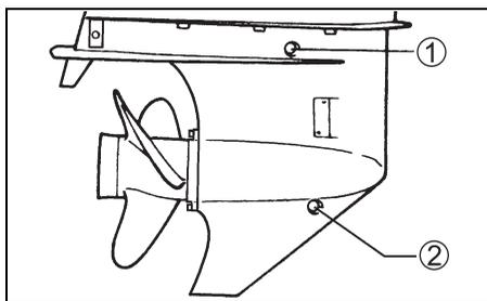
3. Nach völliger Leerung vorgeschriebenes Getriebeöl in die untere Ablassöffnung einspritzen, bis es aus der oberen Kontrollöffnung herauskommt.
