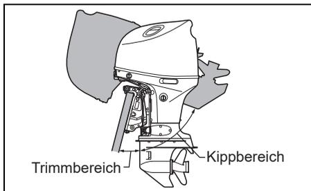
Machen Sie eine Probefahrt, um festzustellen, ob der Trimmwinkel eingestellt werden muss. Stellen Sie den Trimmwinkel mithilfe des Systems der Motoreinstellung und -schwenkung ein. Siehe den Abschnitt "MOTOREINSTELLUNG UND -SCHWENKUNG".
