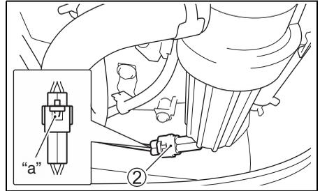
5. Vor dem Abnehmen einen Lappen unter den Filter legen, um verschütteten Kraftstoff aufzufangen.
