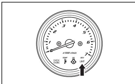
Um vollen Motorbetrieb wieder herzustellen, muss dieses System rückgesetzt werden, indem das Gas etwa eine Sekunde lang auf Leerlauf gestellt wird.
