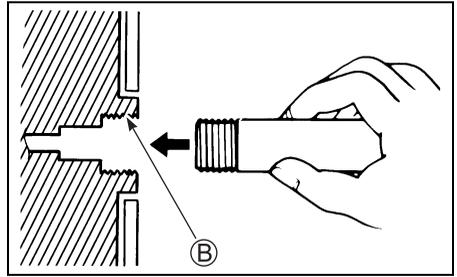
4. Den Wasserhahn aufdrehen, sodass ein guter Wasserstrom gewährleistet ist. Den Motor etwa fünf Minuten lang spülen.
