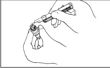
Wenn die Elektrode oder Isolierung beschädigt ist oder beide übermäßigen Verschleiß aufweisen, ist die Zündkerze auszutauschen.
