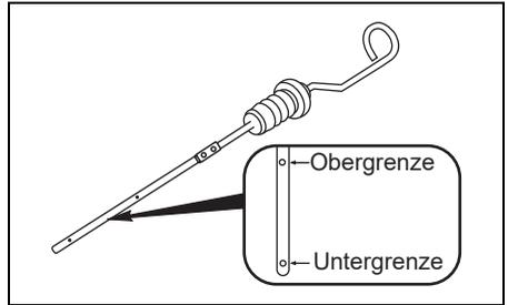
Der Ölstand am Messstab soll zwischen dessen oberer und unterer Grenzmarke angezeigt sein. Wenn sich der Ölstand in der Nähe der unteren Grenzmarke befindet, muss Öl bis zur oberen Grenzmarke nachgefüllt werden.
