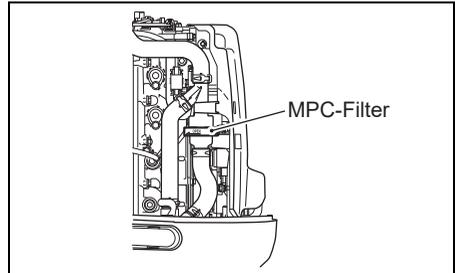
Überprüfen und reinigen Sie den MPC-Filter wie folgt:
