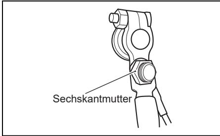
Beim Ausbau der Batterie zuerst das schwarze Kabel vom Minuspol, dann das rote Kabel vom Pluspol abnehmen.
