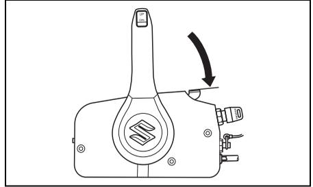
3. Den Zündschlüssel in die Stellung "ON" drehen und anschließend die Multifunktionsanzeige bzw. die Anzeige auf dem Kontrollanzeigen-Drehzahlmesser beobachten. Wenn nichts Ungewöhnliches angezeigt wird, den Schlüssel in die Stellung "START" drehen, um den Motor anzulassen.
