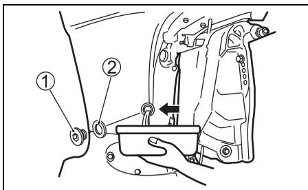
5. Nach dem Ablassen des Öls einen neuen Dichtring einbauen und dann den Motoröl-Ablasstopfen ① mit dem vorgeschriebenen Anzugsdrehmoment anziehen.
