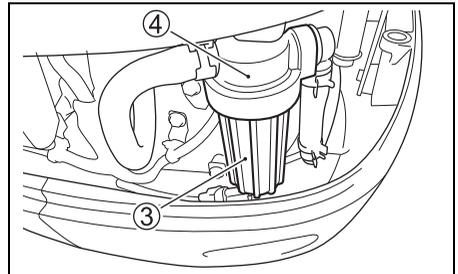
7. Kraftstoff und Wasser von der Filtertasse in einen geeigneten Behälter ablaufen lassen.
