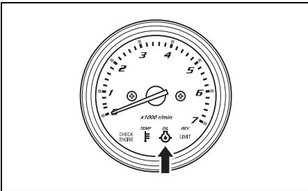
2. Wenn Sie weiterfahren, stoppt der Motor 3 Minuten nach Aktivierung des obigen Warnsystems automatisch.
