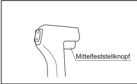
Um in den Vorwärtsgang zu schalten, drücken Sie den Mittelfeststellknopf am Fernbedienungshebel (bei Ausstattung) und schieben Sie den Fernbedienungshebel nach vorn ungefähr bis zur Stellung **A**, wie in der Abbildung gezeigt.
