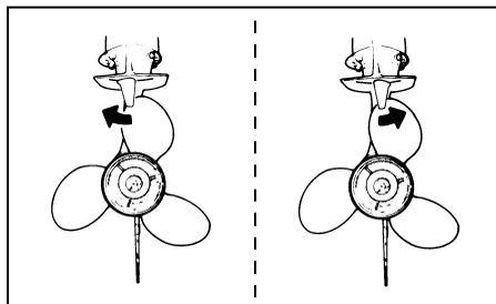
3. Die Schraube **A** mit dem vorgeschriebenen Anzugsdrehmoment festziehen, die das Trimmeruder festhält.
