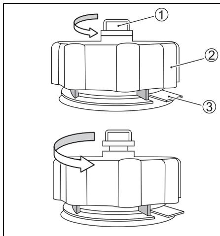
5. Drücken Sie die Lasche nach unten, lösen Sie die Verriegelung und drehen Sie dann den Kraftstofftankdeckel um eine 1/4-Drehung. Die Lasche rastet in die zweite Verriegelung ein.
