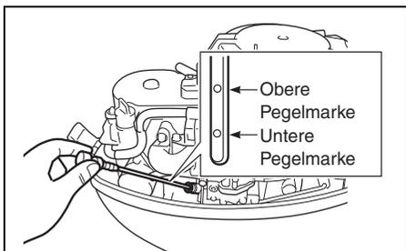
Der Ölstand muß sich zwischen der oberen und unteren Markierung am Ölmeßstab befinden. Wenn der Stand bis in die Nähe der unteren Markierung abgesunken ist, muß Motoröl nachgefüllt werden, bis die obere Markierung erreicht ist.
