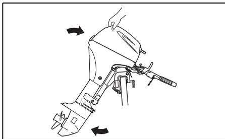
4. Motor langsam bis zur Endstellung absenken, die leicht höher als beim normalen Trimmwinkel ist.
