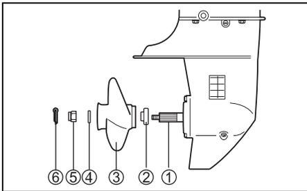
1. Schiebewelle ① der Schiffsschraube dick mit wasserabweisendes Fett gegen Rost einfetten.
