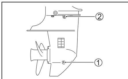
3. Nach völliger Leerung vorgeschriebenes Getriebeöl in untere Abblaßöffnung einspritzen, bis es aus der oberen Öffnung herauskommt. Dafür sind rund 0,25 L Öl erforderlich.
