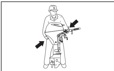
8. Den Außenbordmotor durch Festziehen der Spannschraube am Ständer anhängen.
