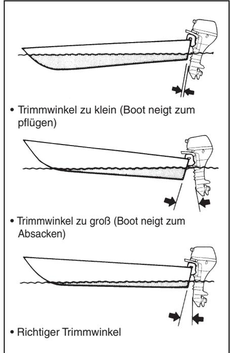
Machen Sie eine Probefahrt, um festzustellen, ob der Trimmwinkel eingestellt werden muss. Einstellen des Trimmwinkels:
