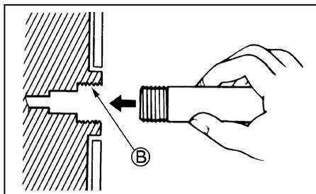
4. Den Wasserhahn aufdrehen, so daß ein guter Wasserstrom gewährleistet ist. Den Motor etwa fünf Minuten lang spülen.
