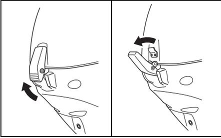
3. Die Schraube ① lösen, den Seilzug NSI ② von Handrücklaufstarter und NSI-Nocken ③ abnehmen.
