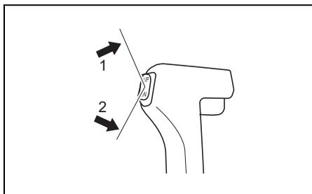
1. Obere Seite des PTT-Schalters (Power Trim und Tilt) (seitlich montiertes Fernbedienungsgehäuse)
