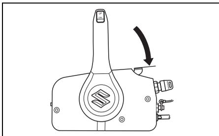
3. Den Zündschlüssel in die Stellung "ON" drehen und anschließend des Multifunktionsinstruments bzw. die Anzeige auf dem Kontrollanzeigen-Drehzahlmesser beobachten. Wenn nichts Ungewöhnliches angezeigt wird, den Zündschlüssel in die Stellung "START" drehen, um den Motor anzulassen. Nach Rückstellung des Zündschlüssels von "START" zu "ON" läuft der Starter bis zum Motorstart 4 Sekunden weiter.
