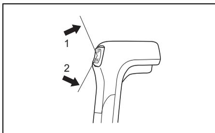
1. Obere Seite des PTT-Schalters (Power Trim und Tilt) (Fernbedienungsgehäuse zur Aufsatzmontage)
