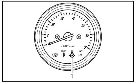
1. "OIL"-Lampe (Kontrollanzeigen-Drehzahlmesser)
